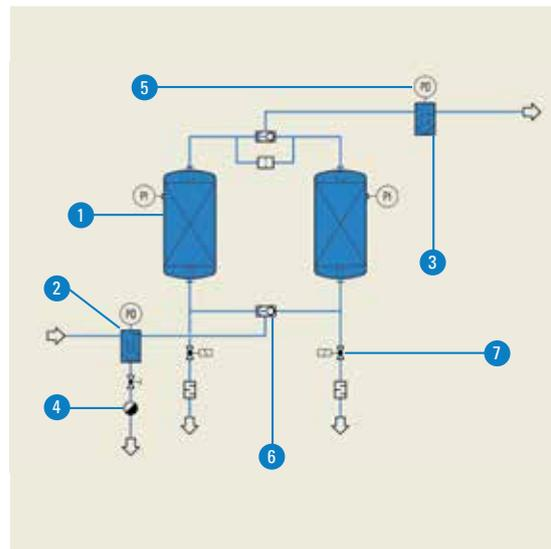
Ein zeitgesteuerter Adsorptionstrockner ohne Kapazitätssteuerung fährt mit festgelegter Taktzeit, und zwar unabhängig davon, ob das Trockenmittel bis zum möglichen Maximum mit Wasser beladen wird, worauf der Trockner ausgelegt ist. Sein Regenerationsluftbedarf (Eigenverbrauch an Druckluft) bleibt somit konstant.
