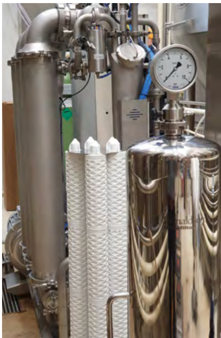
PF-EG Sanitary Filtergehäuse und LifeTec™-Flüssigkeitsfilter in der Testphase bei Tornion Panimo OY (Foto: Donaldson)
