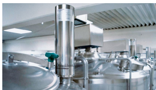
Corpo filtro per l'aerazione di serbatoi di stoccaggio
