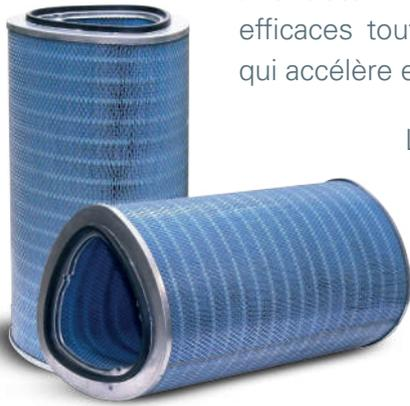
La forme trigonale permet d'accumuler plus de poussière sur la partie basse de la cartouche et la gravité facilite et optimise le nettoyage par l'air pulsé.
