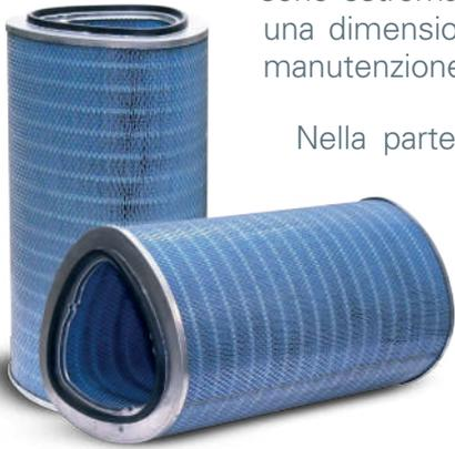
Nella parte inferiore della cartuccia, la forma triangolare consente di accumulare più polvere sul fondo del filtro e sfrutta l'ausilio della gravità per ottenere prestazioni migliori nella pulizia a impulsi.
