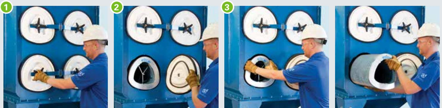
**1** Mit dem Sterngriff lässt sich der Deckel einfach lösen. In der Mitte des Drehknopfs ist eine Vorrichtung für den Einsatz eines Elektrowerkzeugs.
