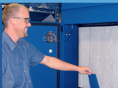
Ein Schwenkebel fixiert das Haupt-Filterelement
