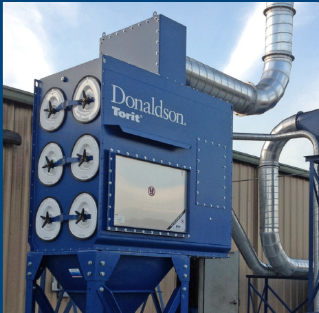
Painel de alívio de explosão
