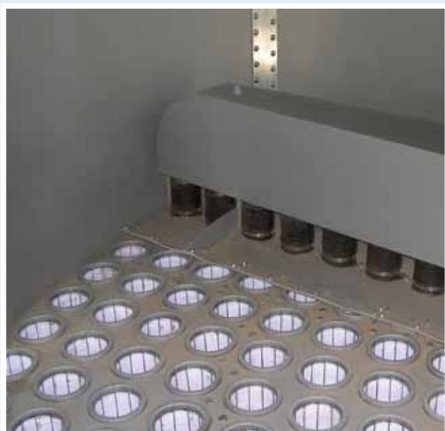
El brazo de limpieza del LP incluye una placa de obstrucción de flujo, la cual impide que el flujo de aire pase a través de las mangas recién limpiadas, para así reducir la re-ingesta del polvo
