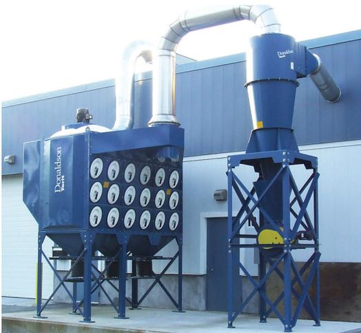
**DFO y ciclón en pulverización térmica**
