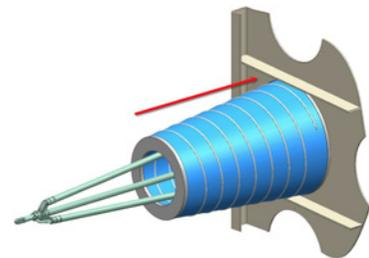
**2** Segundo paso es instalar el sello de rondana en el segundo elemento filtrante.
